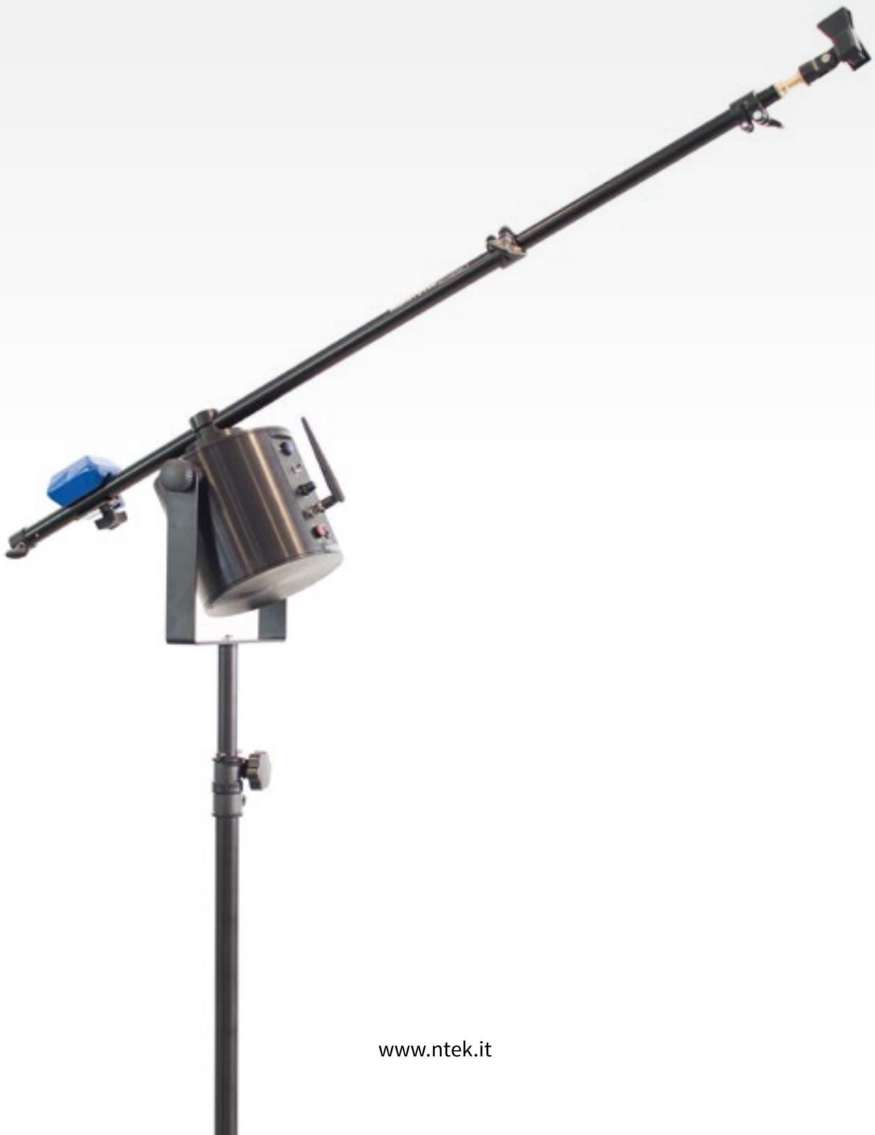
L'asta rotante MB 01 permette di alloggiare un microfono a movimento meccanizzato per eseguire delle misure spaziali del livello di pressione sonora.
