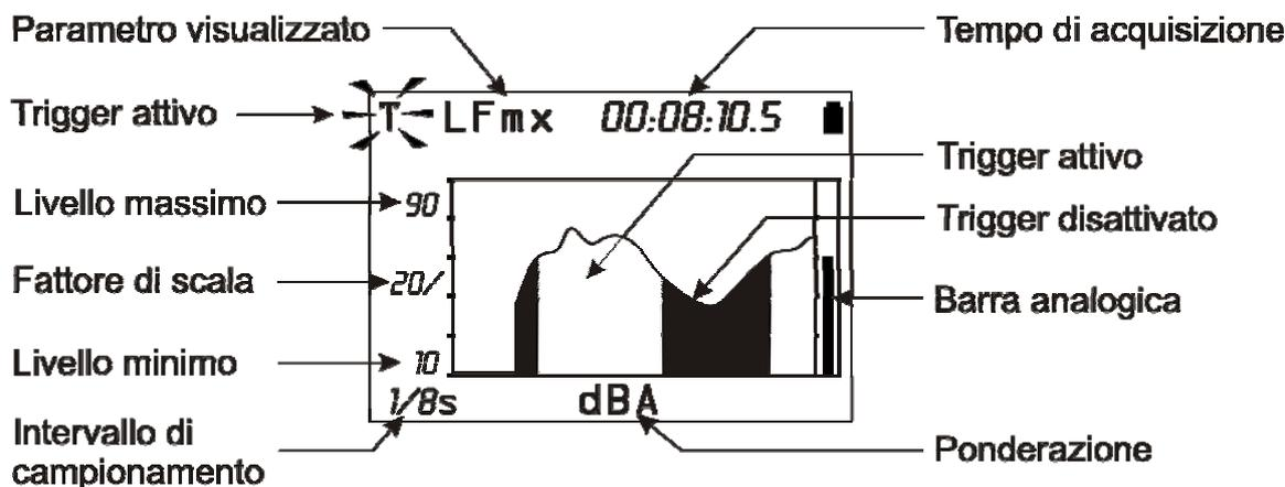
Fig. 9 - Descrizione del display in modalità "Trigger d'evento"
