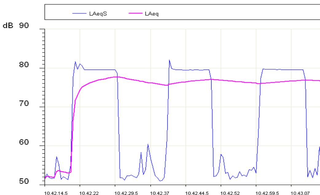
Nell'arco del tempo di misura, il profilo del Leq Short (indicato come LAeqS) evidenzia tre fasi con livello di rumore piuttosto elevato, pari a circa 80 dB, ed un rumore di fondo con una certa variabilità nell'intervallo 52 - 60 dB.
