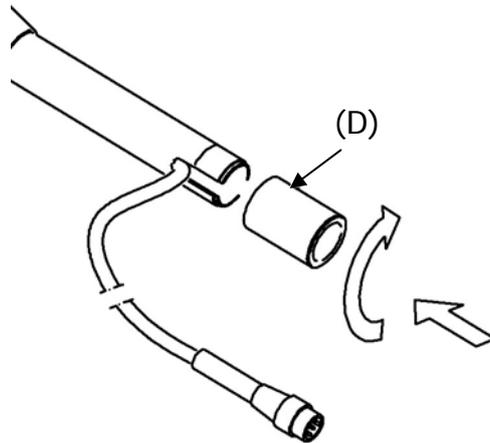
8. Per fissare la protezione per esterni si può usare il terminale filettato (D) oppure si può applicare il raccordo (E) ad un cavalletto. Il terminale (E) prevede due filettature da  $\frac{1}{2}$ " e da  $\frac{1}{4}$ ".
