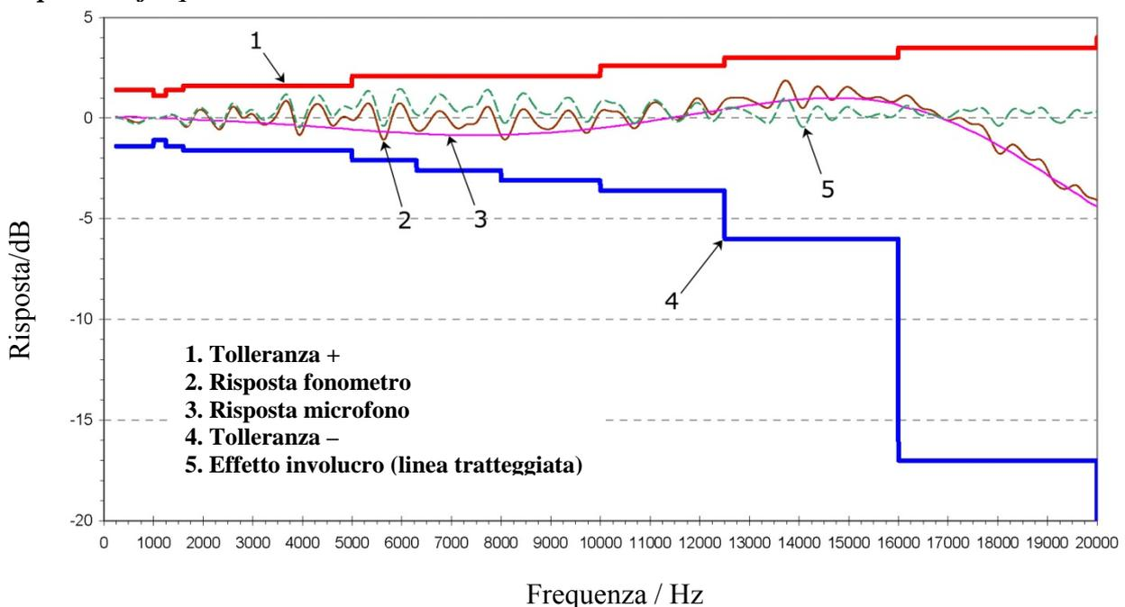
La selezione di microfoni UC52, in base alle caratteristiche della risposta, e le correzioni spettrali calcolate dal DSP del fonometro, permettono di ottenere una risposta in frequenza in campo libero in classe 1 secondo la IEC61672:2002. Il fonometro HD2010UC è anche disponibile in versione classe 2.
