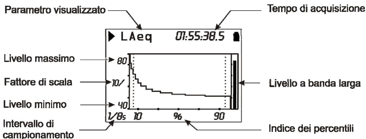
**Fig. 7 - Descrizione del display in modalità Livelli Percentili**
