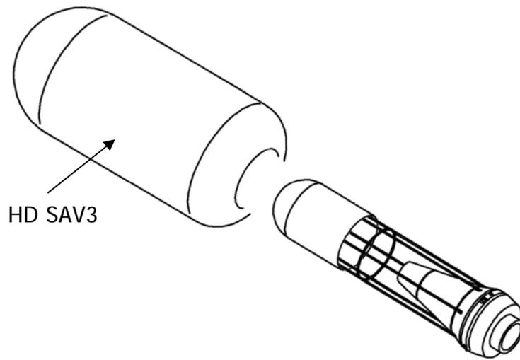
3. Applicare il dissuasore per volatili e fissarlo mediante le tre viti a testa esagonale poste sul supporto alla base dello schermo antivento.
