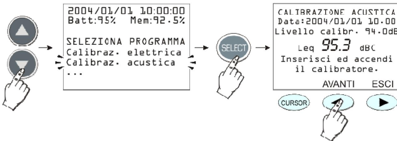
2. La prima schermata riporta la data dell'ultima calibrazione (Data:...) e, nella riga successiva, il livello sonoro del calibratore da usare nella calibrazione in corso (questo valore può essere modificato, prima di avviare il programma di calibrazione, alla voce "Livello Calibratore" del MENU: si veda a pag.40). Inserire il microfono nella cavità del calibratore e quindi accenderlo.
