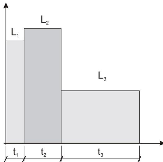
$$L_{eq,T} = 10 \cdot \log_{10} \left[ \frac{T_1 \cdot 10^{\frac{L_{eq,1}}{10}} + T_2 \cdot 10^{\frac{L_{eq,2}}{10}} + T_3 \cdot 10^{\frac{L_{eq,3}}{10}}}{T_1 + T_2 + T_3} \right]$$
