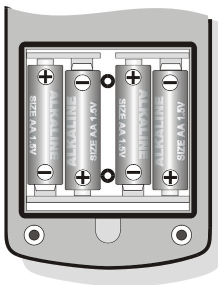
In alternativa alle batterie alcaline è possibile utilizzare batterie ricaricabili. Le batterie con minore capacità presentano in genere una maggiore impedenza, causando un peggioramento del rumore elettrico generato dal fonometro, con ripercussioni sulla dinamica di misura. Sono pertanto sconsigliate le batterie zinco-carbone e le ricaricabili NiCd.
