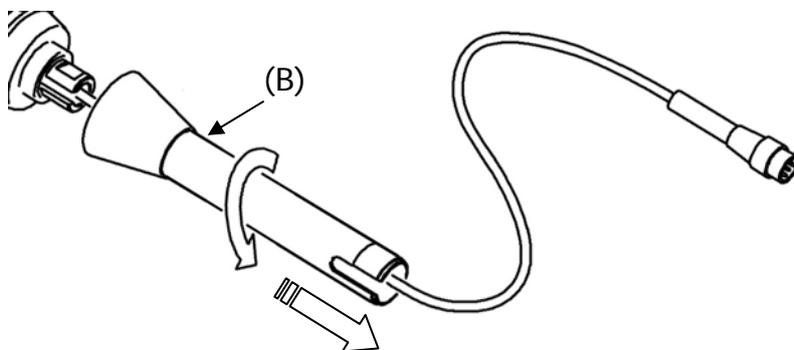
5. Svitare la ghiera di fissaggio del preamplificatore (C) servendosi, se necessario, di una chiave esagonale da 14mm. Fare attenzione a non torcere il cavo del preamplificatore.
