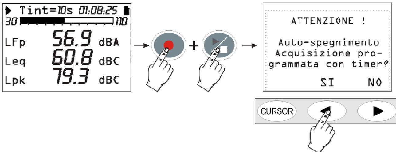
Fig. 12 - Schermata di avviso dell'acquisizione automatica con timer
