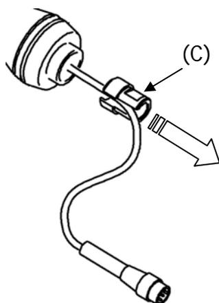
6. Estrarre il preamplificatore (D) tirandolo lentamente verso il basso. A questo punto la capsula microfonica è accessibile ed è pertanto possibile procedere con la calibrazione.
