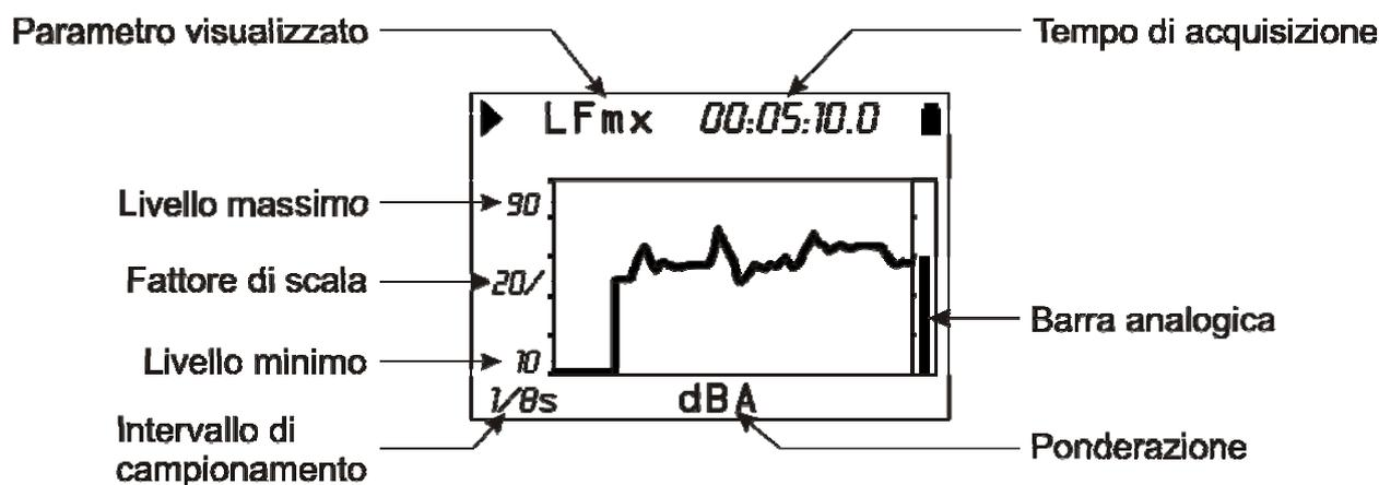
**Fig. 5 - Descrizione del display in modalità Profilo**
