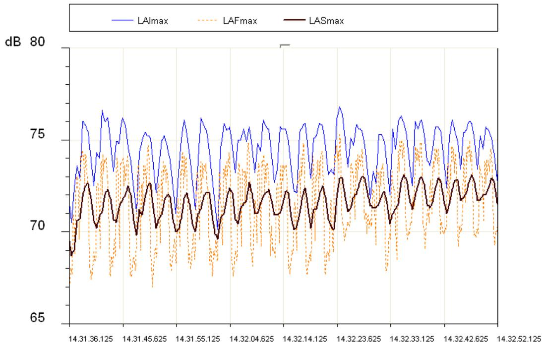
Nel caso una sorgente sonora emetta rumori con marcata componente impulsiva, si misurerà un livello con costante IMPULSE molto maggiore di un livello con costante SLOW. Nella figura è rappresentato il profilo del livello sonoro, misurato simultaneamente con costante di tempo FAST, SLOW ed IMPULSE, di una macchina per montaggio superficiale.
