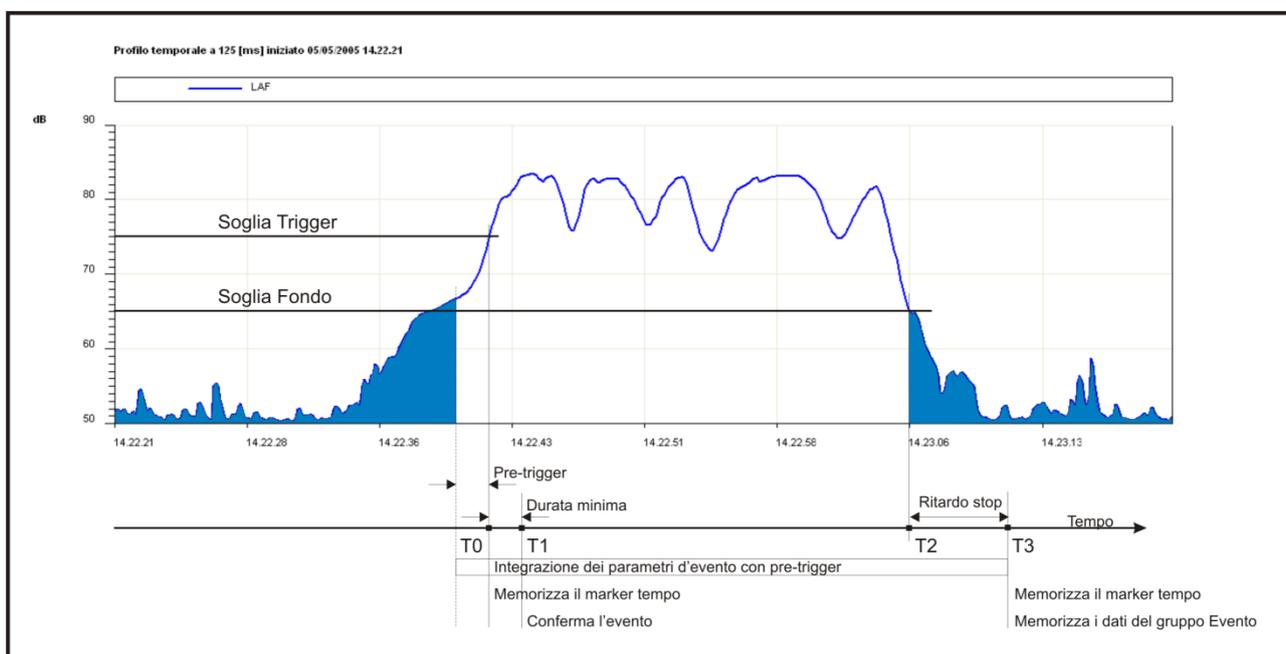
**Fig. 8 - Descrizione dei parametri del trigger d'evento**
