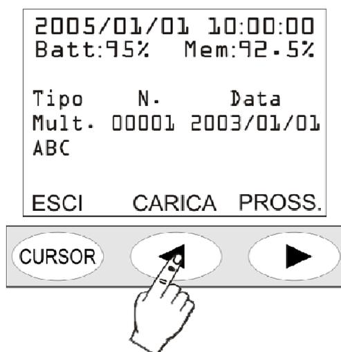
Per ogni file sono indicati: il tipo di file (se singolo, multiplo o automatico), il numero progressivo assegnato dallo strumento al momento della memorizzazione e la data. Per passare al file successivo premere il tasto PROSS., per caricare il file corrente premere CARICA. Premendo CARICA, lo strumento torna in visualizzazione standard ed i simboli di STOP e di batteria si alternano alle lettere R (Replay) e P (Programma).
