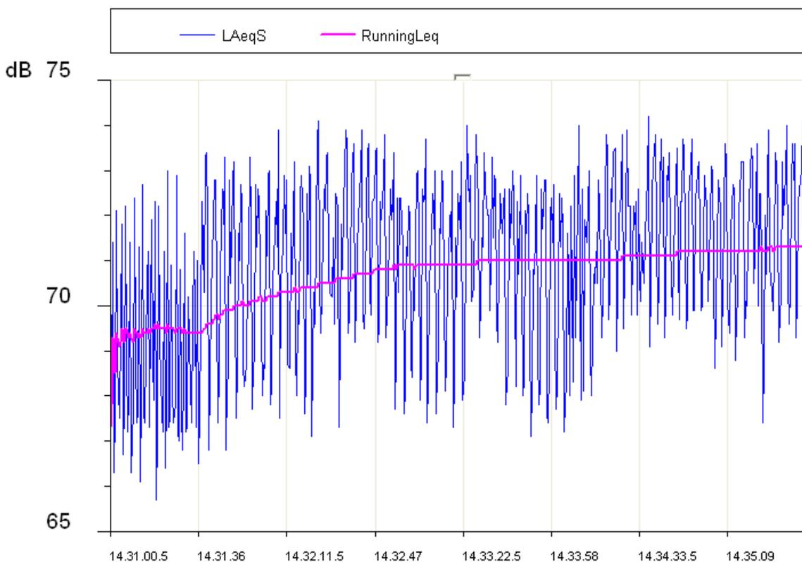
Nella figura è evidenziato il profilo del livello equivalente che va stabilizzandosi entro qualche minuto ad un livello di poco superiore ai 71 dBA.
