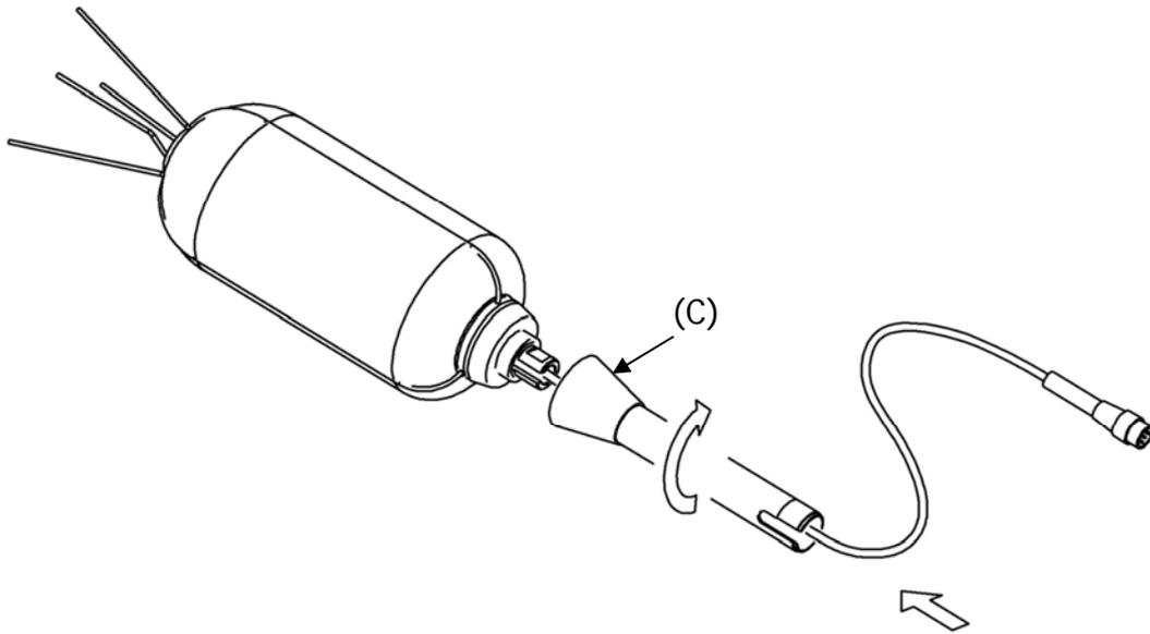
7. Avvitare il terminale posto all'estremità inferiore dello stelo (D) facendo uscire il cavo lateralmente.
