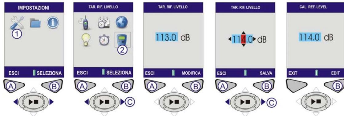
Figure 9 Livello di riferimento taratura
