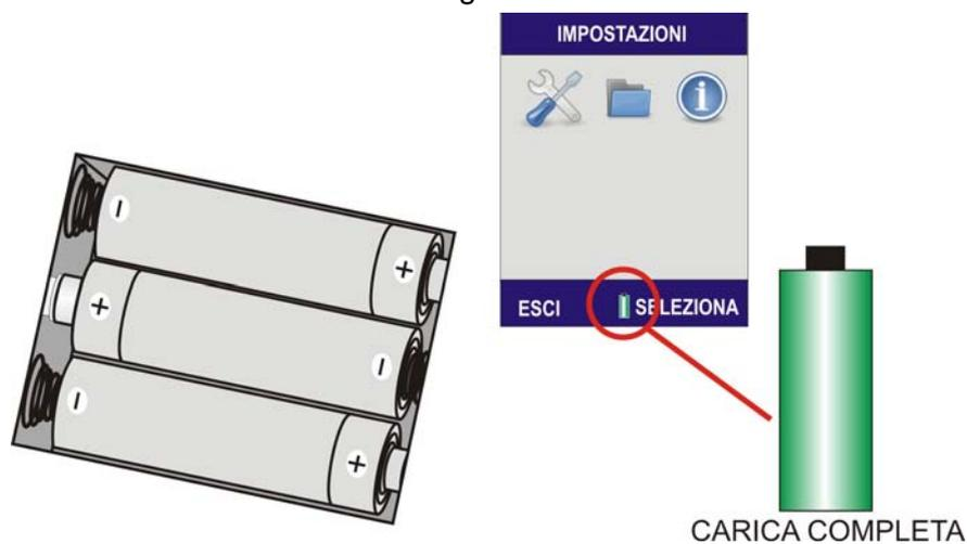
Figura 2 Indicatore di carica della batteria e installazione delle batterie.
