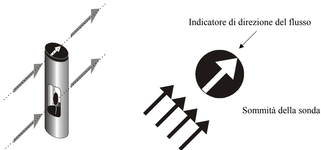
La sonda va mantenuta ortogonale al flusso e non va inclinata rispetto ad esso:
