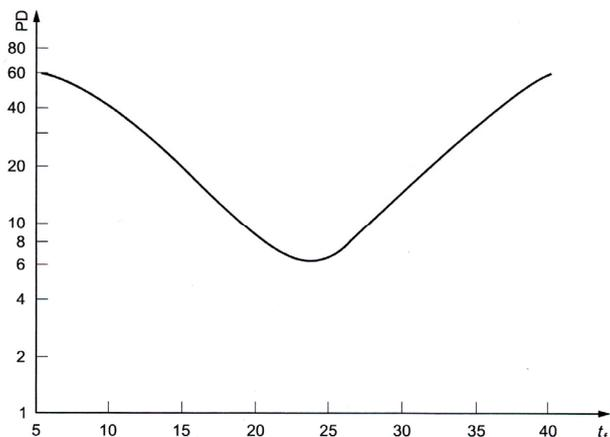
Per il calcolo dell'indice  $PD_f$  (insoddisfatti da temperatura di pavimento) è necessario che sia collegata la seguente sonda:
