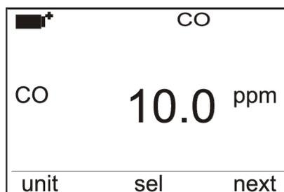
La prima riga del display riporta la sigla “CO”, indicando che a display è visualizzata la misura della **concentrazione di monossido di carbonio** rilevata dalla **sonda di CO**, completa di modulo SICRAM.
