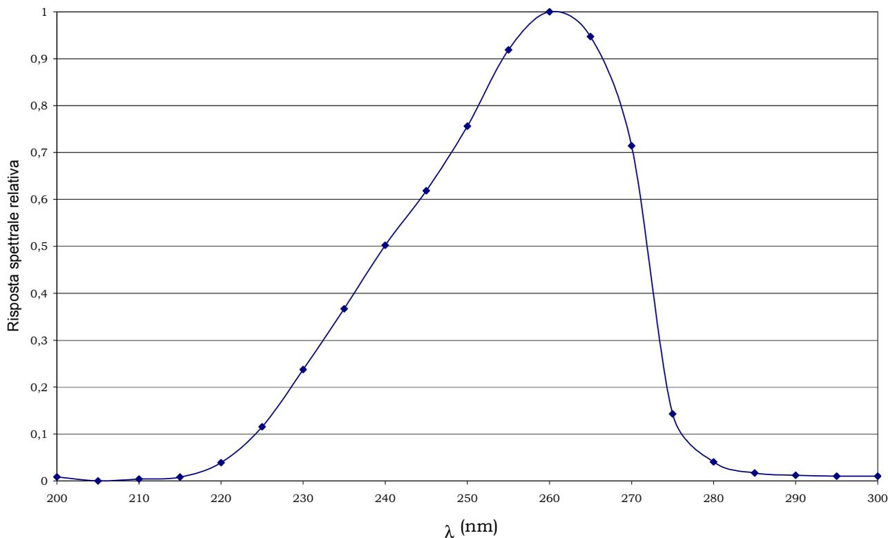
**Sonda di misura LP 471ERY dell'irradiamento totale efficace ( $W/m^2$ ) ponderato secondo la curva di azione UV (CEI EN 60335-2-27) completa di modulo SICRAM, in linea con lo strumento**
