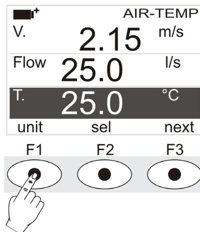
Premendo il **tasto funzione F3** quando sull'ultima riga del display è presente la scritta **next** si passa alla visualizzazione delle misure rilevate dalle **sonde di luce**, complete di modulo SICRAM, con la seguente visualizzazione:
