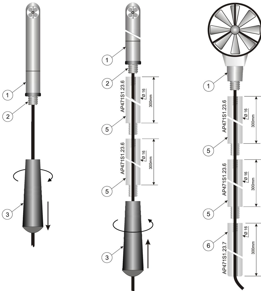
Le sonde **AP472 S1 - AP472 S2** oltre all'asta di estensione telescopica con la testa orientabile possono impiegare l'asta prolunga rigida  $\varnothing 16$ mm. Per svitare l'impugnatura (3) tenere fermo il corpo della sonda nel punto (1). Avvitare la sommità dell'asta **AP471S1.23.6** (5) sulla vite (2). E' possibile aggiungere altre aste di estensione **AP471S1.23.6**. L'ultimo elemento può essere l'impugnatura (3) o l'asta di estensione **AP471S1.23.7** (6).
