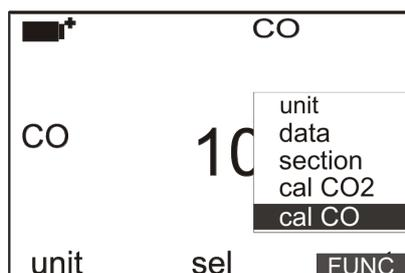
3. Appare la schermata per l'operazione da eseguire sul sensore (calibrazione o sostituzione):
