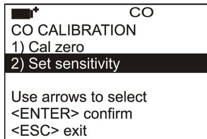
8. Con le frecce Up e Down selezionare “Set sensitivity” e confermare con ENTER. Appare la schermata per la sostituzione del sensore CO.
