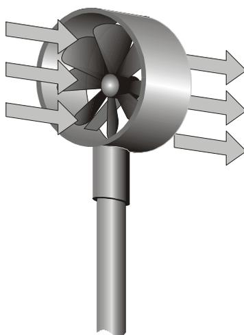
La sonda va mantenuta ortogonale al flusso e non va inclinata rispetto ad esso:
