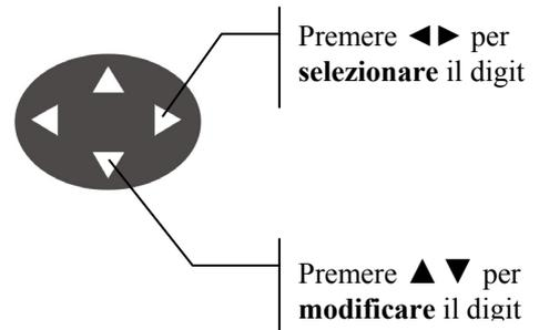
Con i tasti di navigazione ◀▶ si evidenziano i digit della sezione. Con i tasti di navigazione ▲▼ si modifica il valore del digit evidenziato.
