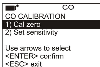
4. Con le frecce Up e Down selezionare "Cal zero" e confermare con ENTER. Appare la schermata per la calibrazione del sensore CO.
