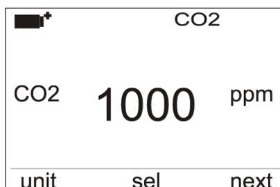
La prima riga del display riporta la sigla “CO<sub>2</sub>”, indicando che a display è visualizzata la misura della **concentrazione di biossido di carbonio** rilevata dalla **sonda di CO<sub>2</sub>**, completa di modulo SICRAM.
