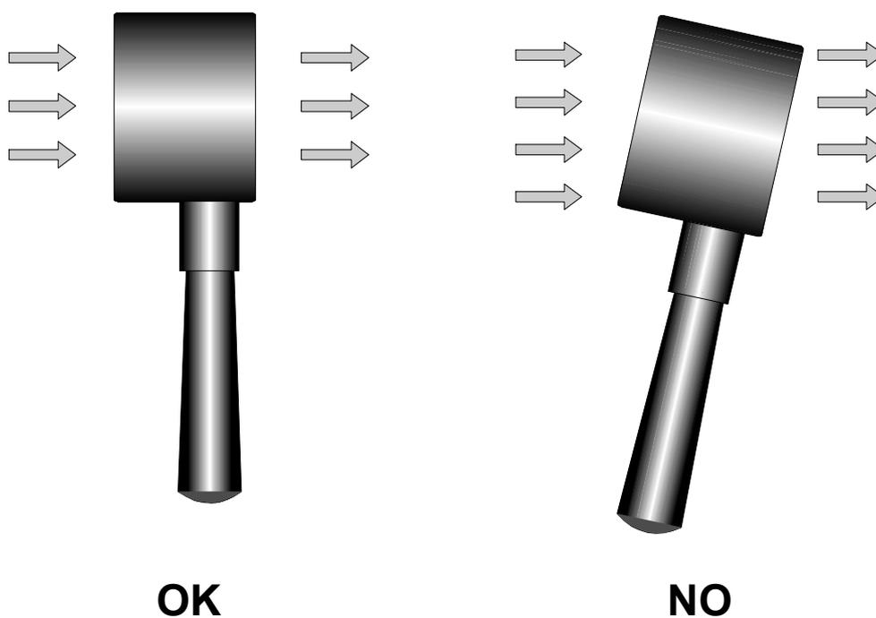
La sonda è posizionata correttamente nel flusso d'aria quando il valore rilevato è massimo. Procedere con la misura seguendo le indicazioni fornite nei paragrafi introduttivi di questo capitolo.
