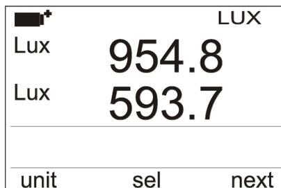
La riga in alto a destra del display riporta la sigla “LUX”, indicando che a display vengono visualizzate le misure delle **sonde di luce**, complete di modulo SICRAM.
