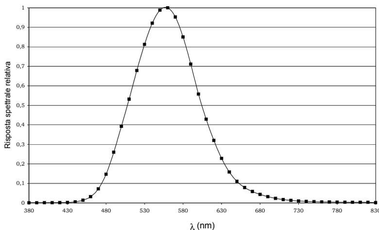
**Sonda quanto-radiometrica per la misura del flusso di fotoni nel campo della clorofilla PAR LP 471
