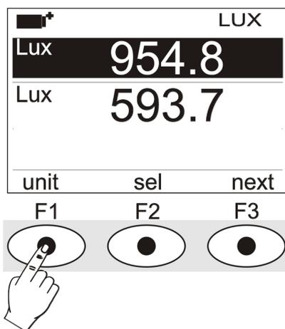
Le unità di misura visualizzabili dipendono dal tipo di sonda inserita:
