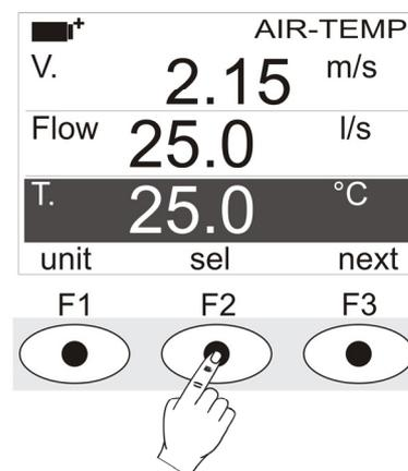
Premendo il **tasto F1**, quando è selezionata la seconda riga, si modifica l'unità di misura della velocità dell'aria:
