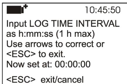
Con le frecce modificare il tempo impostato, il valore massimo ammesso è 1 ora.
