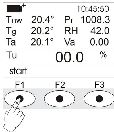
Per avviare la procedura di acquisizione premere il tasto **F1**; sulla prima riga appare il simbolo **TU** lampeggiante e la scritta **start** è sostituita dalla scritta **running**, indica che la procedura è avviata.
