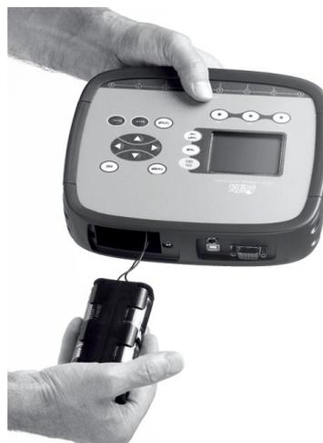
Lo strumento può essere alimentato da rete con, per esempio, l'alimentatore stabilizzato SWD10 ingresso 100÷240 Vac uscita 12 Vdc – 1000mA.
