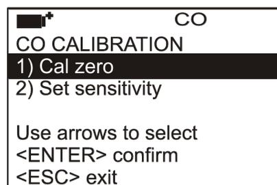
5. Con le frecce Up e Down selezionare “Cal zero” e confermare con ENTER. Appare la schermata per la calibrazione del sensore CO.
