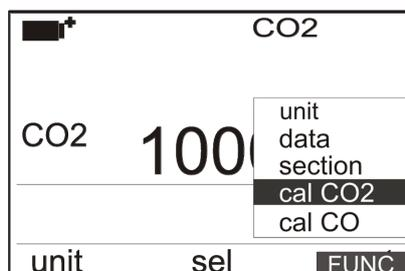
5. Erogare per almeno 2 minuti CO2 in modo che la misura si stabilizzi.
