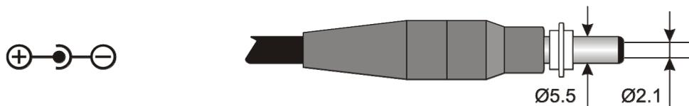
Il connettore dell'alimentatore esterno ha diametro esterno 5.5mm e diametro interno 2.1mm.
