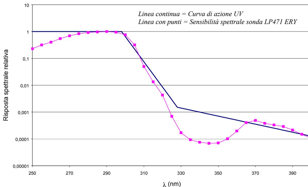
La sonda LP 471 ERY misura l'irradiamento totale efficace ( $W/m^2_{eff}$ ) ponderato secondo la curva di azione UV (CEI EN 60335-2-27). Il particolare foto-diode insieme ad una opportuna combinazione di filtri rendono la risposta spettrale della sonda vicina alla curva di azione UV.
