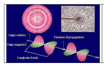
Le onde elettromagnetiche, secondo la teoria di Maxwell, sono fenomeni oscillatori, generalmente di tipo sinusoidale, e sono costituite da due grandezze che variano periodicamente nel tempo: il campo elettrico ed il campo magnetico. In condizioni di campo lontano i due campi sono in fase, ortogonali tra loro e trasversali rispetto alla direzione di propagazione.
