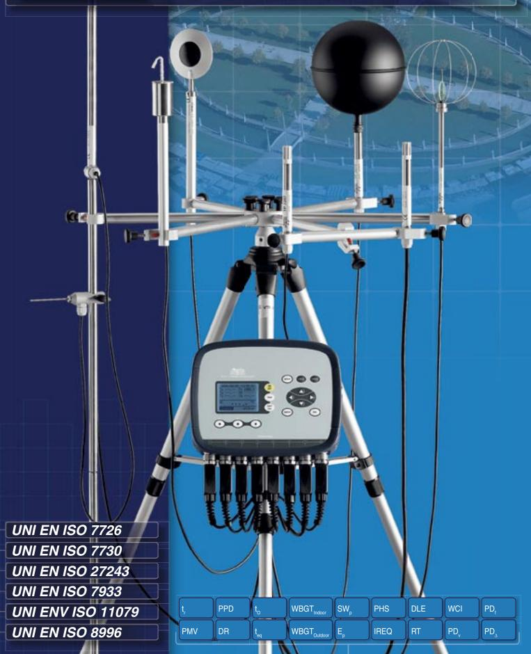
L' HD32.1, Thermal Microclimate è uno strumento realizzato da Delta Ohm SrI per lo studio, la misura e la verifica del Microclima negli ambienti di lavoro, secondo le normative:
