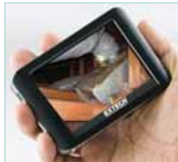
Il visualizzatore LCD TFT a colori da 89mm senza fili staccabile può essere visto da lontano fino a 10 metri dal punto di misurazione.
